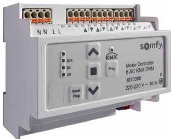
Motor Controller destiné au montage dans une armoire électrique (DRM) pour la commande de brise-soleil orientables, protections solaires textiles, volets roulants, ouvertures de fenêtre. Pour la commande individuelle de 6 moteurs 230 V C.A. via la technologie de commande KNX. Compatible avec le configurateur Somfy TaHoma KNX et les centrales animeo KNX.
